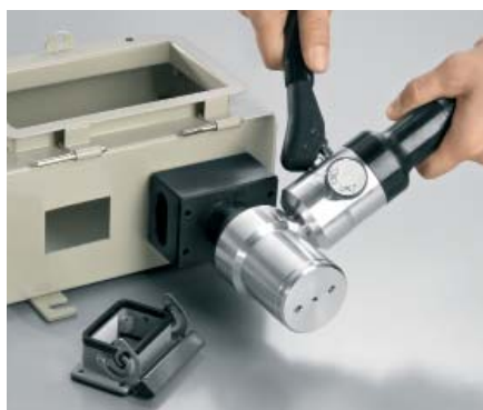
Автоматическая вырубка по центру в вершине сверла при пробивке отверстий для промышленных разъемов.
