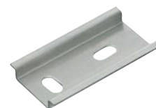
TS 35/7.5 мм согласно EN 50022 (s = 1.0 мм)
