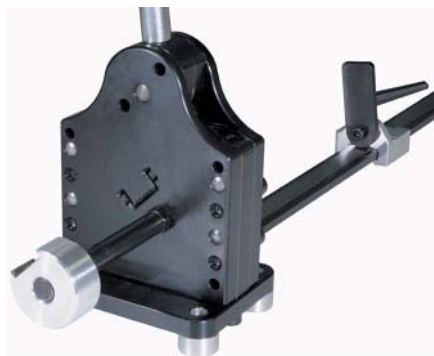
TS 35/7.5 мм согласно EN 50022 (s = 1.0 мм)
