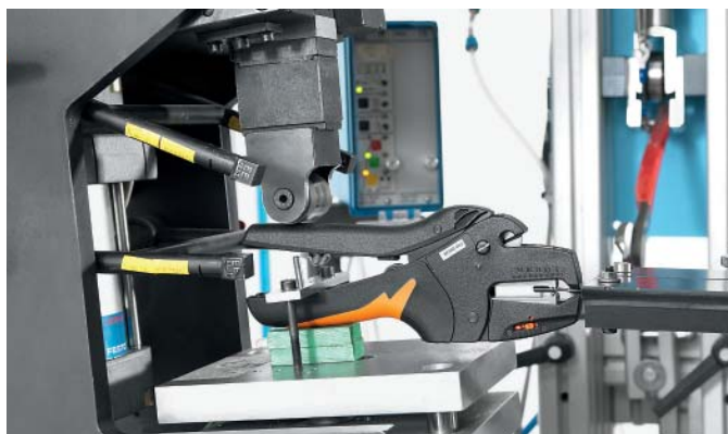
Проведение испытаний на выносливость Stripax® в лаборатории Weidmüller
