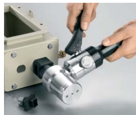
Пробитые отверстия для различных промышленных разъемов Ethernet.
